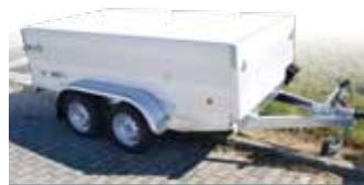
Anhänger VZ 31 B2 mit erhöhten Alu-Bordwänden und Alu Deckel
