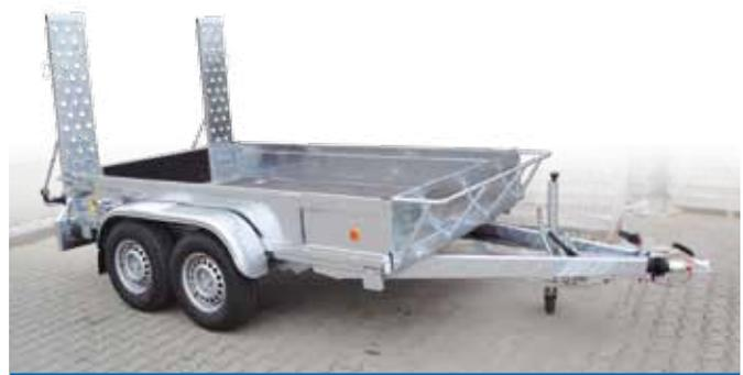
Hinten integrierte Stahl-Auffahrschienen mit hoher Tragfähigkeit
