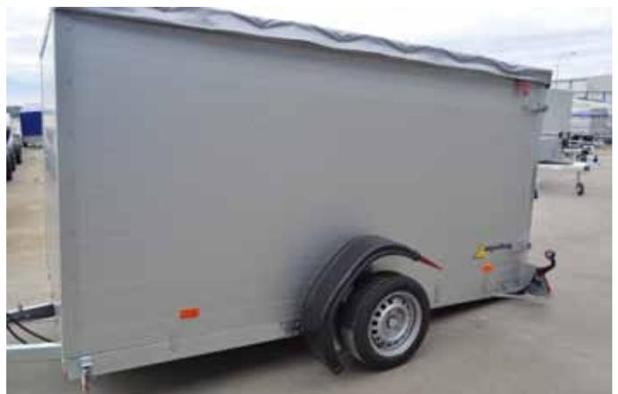
Absenkanhänger mit Alukoffer und Schiebeplanendach
