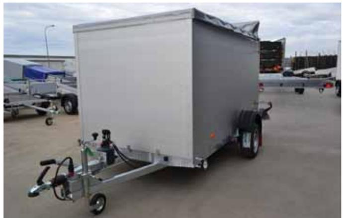
Absenkanhänger mit Alukoffer und Schiebeplanendach
