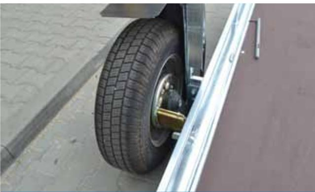
Hydraulisch absenkbare Achse
