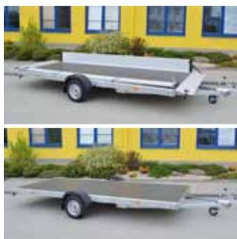
einfache Demontage der Bordwände, Ausführung Plateau
