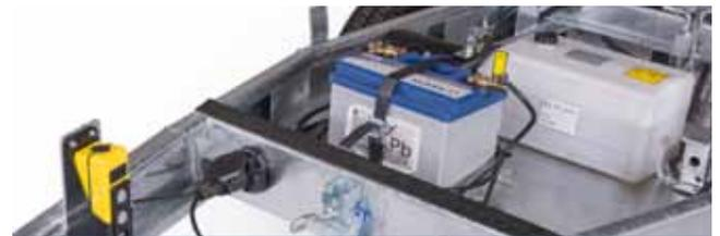
Elektrische Hydraulik mit Batterie
