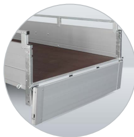
Rückwand komplett klappbar + abnehmbar
