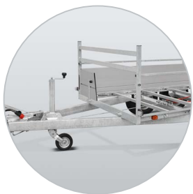
Robotergeschweißtes Chassis mit fester Reling und Vorgitter
