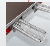
Unterm Ladeboden integrierte Auffharrampen
