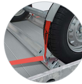
Zubehör: Radstopper mit Bindemöglichkeiten
