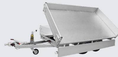
KSX Rückwärtskipper oder 3-Seitenkipper elektrische Pumpe
