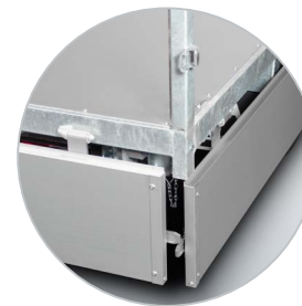
Seitenbordwände öffnen sich bis unter den Ladeboden für ein beschädigungsfreies Be- und Entladen
