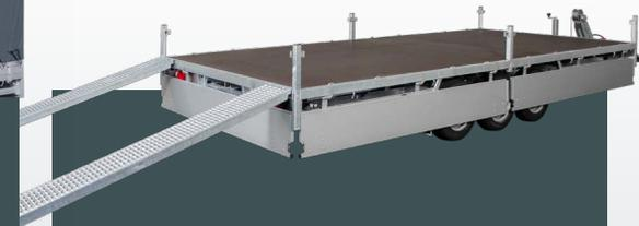
Sie können die Bordwände leicht demontieren und den Medax als flachen Plattformwagen nutzen.
