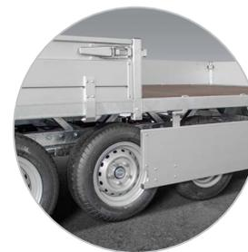
Geteilte Seitenwände ab 5 Metern Länge
