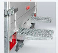
Auffahrrampen, die unter der Ladefläche aufbewahrt werden
