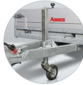
Lange Deichsel mit klappbarem Stützrad
