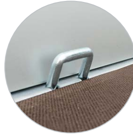
8 Bindehaken an der Innenseite der Ladefläche
