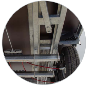
Starker Rahmen mit integrierter Auffahrrampenhalterung
